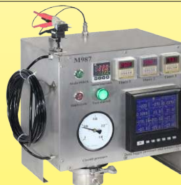
Apparecchiatura di test per misurare ripetutamente e costantemente la lunghezza massima dei tubi di collegamento degli interruttori pneumatici in funzione del volume del pulsante e della pressione che sviluppa (Laboratorio Ultimheat)
